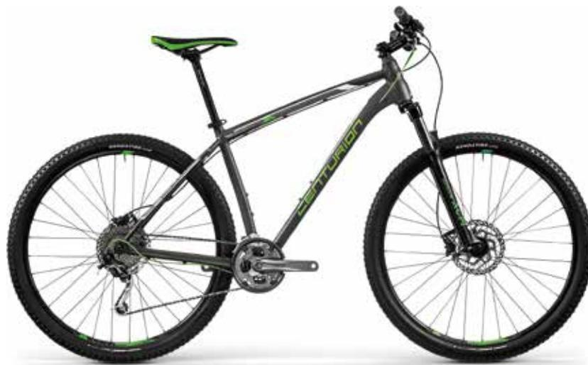
**Backfire Pro 200****899,00 €****Farbe** mattschwarz (grau/grün)**Rahmen** Backfire Pro**Größen** XS, S, M, L, XL**Gabel** SR Suntour XCM 30 HLO**Bremse** Shimano MT200**Kurbelgarnitur** Shimano FC-M4000, 40/30/22T**Schaltwerk** Shimano Deore XT M772, 9-speed**Kassette** Shimano HG200, 11-36T**Reifen** Kenda Honey Badger XC, Wire TT**Gewicht** 14,1 kg
